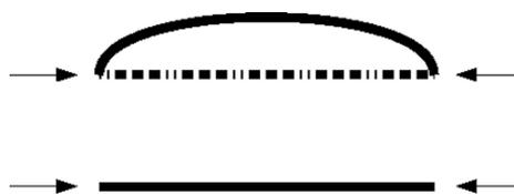
FIGURE 1.6 – Illustration de la force de compression sur le flambage d'une tige pour  $F < F_c$  (bas) et  $F > F_c$  (haut).
